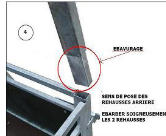
EBARBER SOIGNEUSEMENT L'INTERIEURE DES 4 ANGLES DE LA REMORQUE AVANT LA POSE DU PORTE ECHELLE A L'AVANT AINSI QUE DES REHAUSSES ARRIERE
