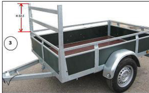
POSE DU PORTE ECHELLE A L'AVANT DE LA REMORQUE ( Si votre Remorque est déjà équipé d'un porte échelle , vérifier que la hauteur corresponde au Rehausse AR )
